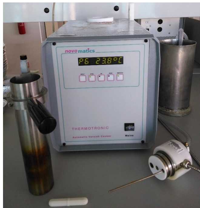
Figura 40 - Material constituinte do aparato 3: Thermotronic 200 , magneto, tubo metálico e tampa com sonda de temperatura acoplada.
