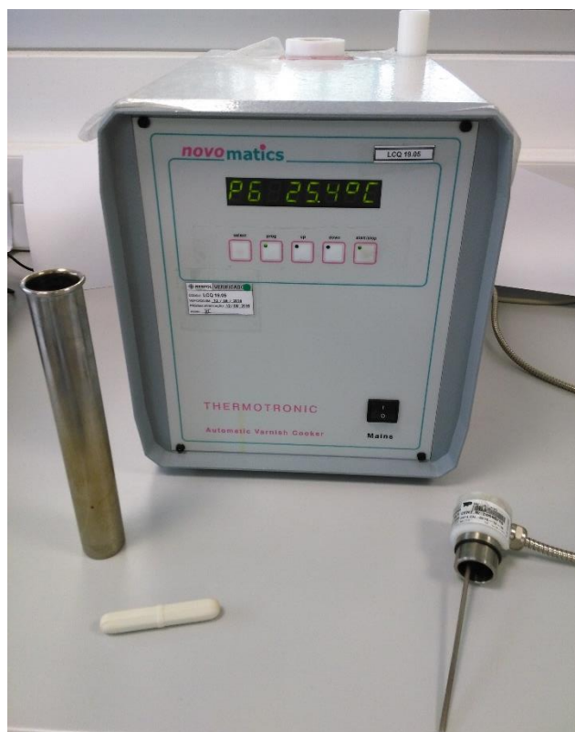
Figura 41 - Material constituinte do aparato 4: Thermotronic II, magneto, tubo metálico e tampa com sonda de temperatura acoplada.
