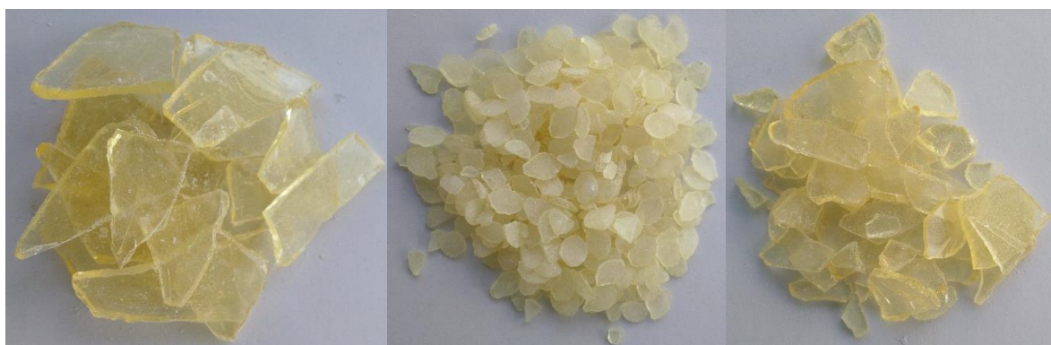
Figura 20 - Flocos de ésteres de colofónia e pentaeritritol.
