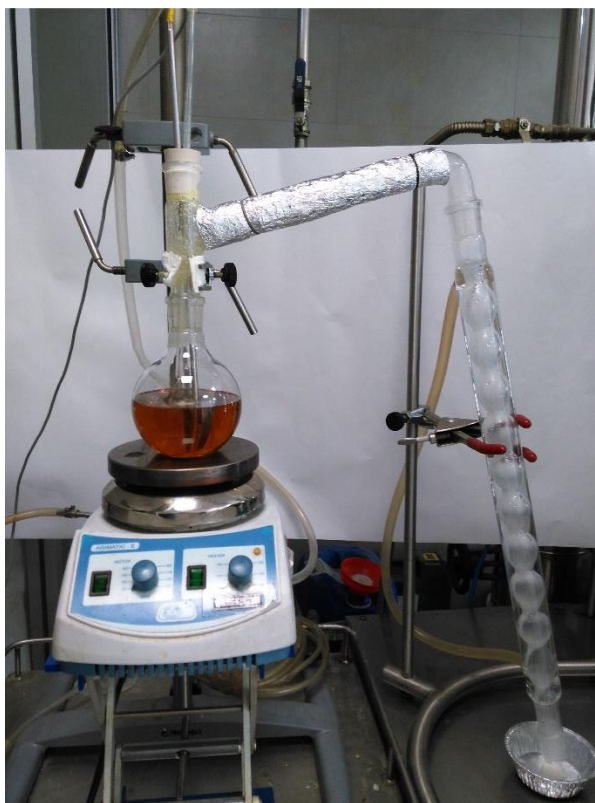
Figura 55 - Aparato laboratorial para a realização dos ensaios de gás inerte nas esterificações.
